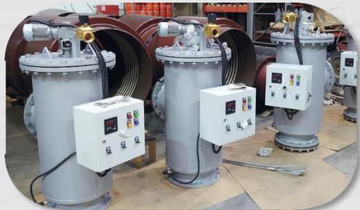
Единая информационно-управляющая система состоит из шкафов управления, объединенных с помощью цифровой связи – CAN шины. Каждый из шкафов содержит электронные устройства автоматики и настроен на работу с одним механизмом.
